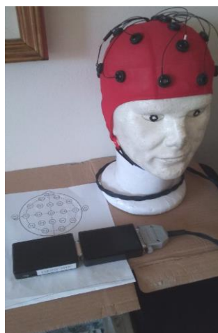
Figura 1: Cuffia EEG Bionen (FI) ed Emotiv Epoc™ modificato.
