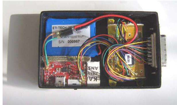
Fig. 2. The disassembled Emotiv Epoc
